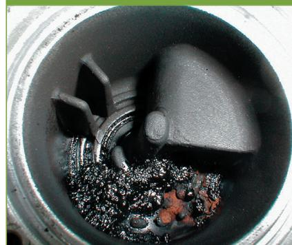
石油ファンヒーターは機器内の気化器にタールが溜まり、点火・消火時に白煙が発生します。
